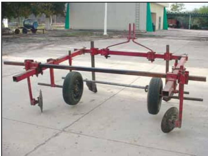
**Figura 5. Acolchadora mecánica tipo CENID-RASPA.**
